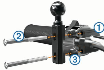
**HINWEIS:** Im Lieferumfang sind sowohl standardmäßige 1/4-Zoll-Schrauben als auch M6-Schrauben enthalten. Verwenden Sie die Schraubengröße, die mit den werkseitig verwendeten Schrauben der Klemmhalterung für den Kupplungs- oder Bremshebel übereinstimmt.
